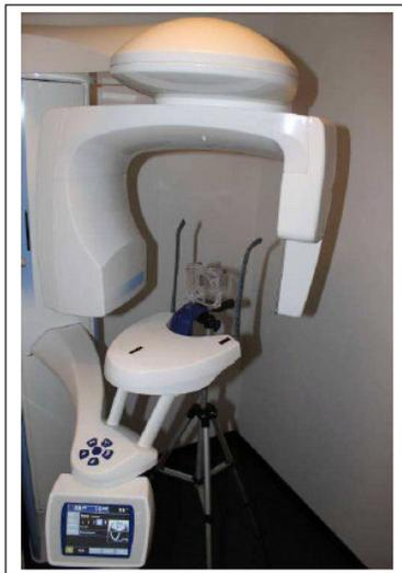
Contrôler que l'objet test est parfaitement de niveau dans le plan tomographique
