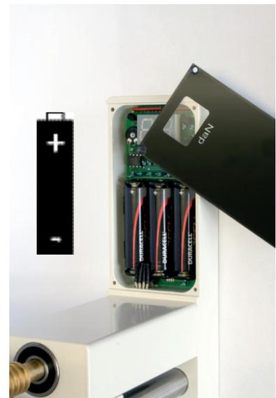
Remplacer les batteries de type AA (prendre garde à la bonne polarité).
