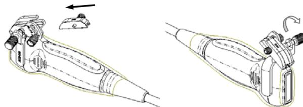
5. Vissez l'écrou du bloc de guidage afin de le maintenir en position.
