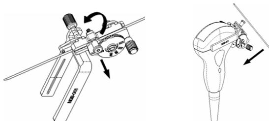
2. Séparez l'aiguille du guide-aiguille et de la sonde.
