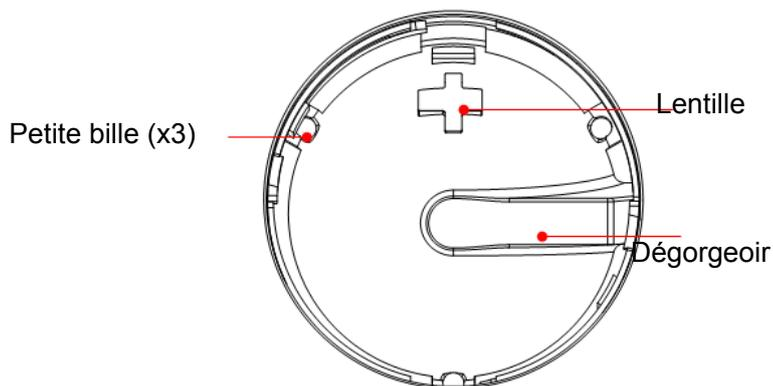
Si du liquide est vaporisé sur la boule de commande, la majeure partie de ce liquide s'évacue par le dégorgeoir. Vous pouvez terminer de sécher le dispositif à l'aide du chiffon.
