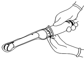
2. Ouvrez la bride de retenue, alignez le guide-aiguille avec la sonde de manière à ce que le bourrelet de positionnement du guide-aiguille soit face aux rainures de positionnement de la sonde, puis tournez la bride de retenue afin de maintenir cette position.
