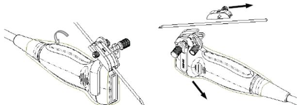
2. Séparez le reste du guide-aiguille et la sonde de l'aiguille.
