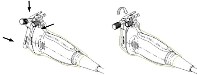
3. Vissez la noix de serrage du guide-aiguille afin de fixer ce dernier sur la sonde.
