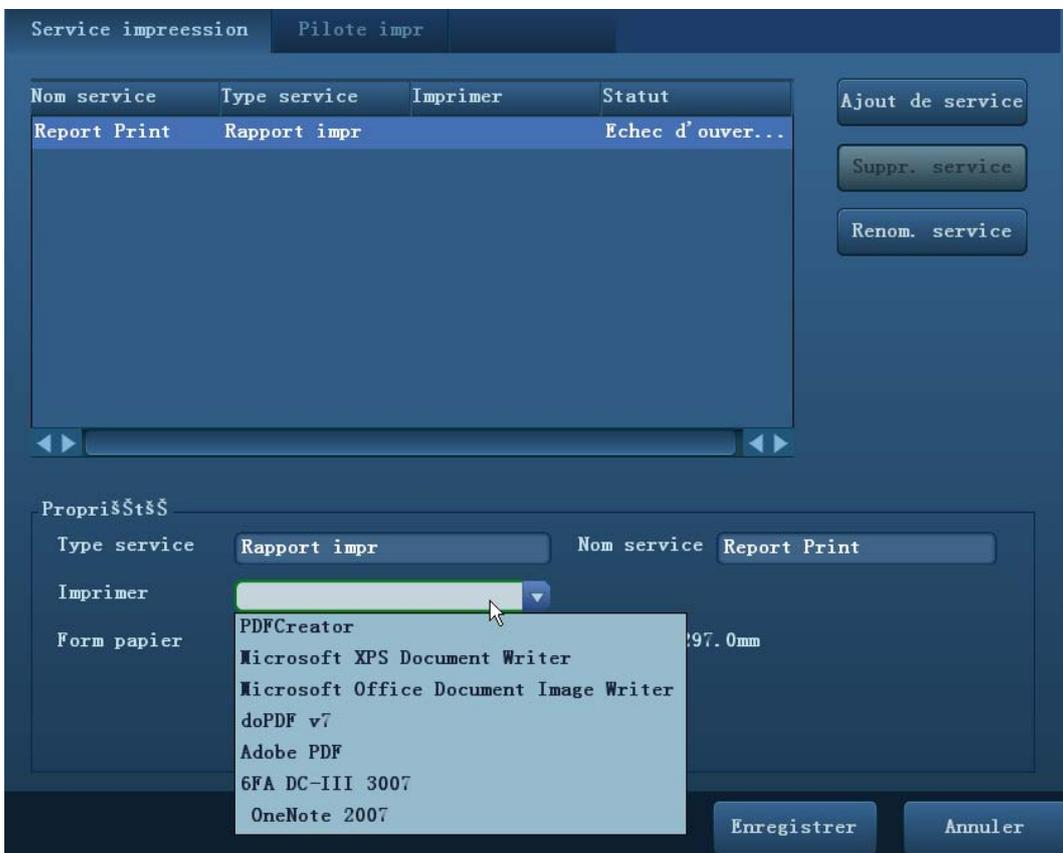
Les pilotes de certaines imprimantes HP sont déjà intégrés au système et seront installés automatiquement. Si l'installation automatique échoue, une icône d'avertissement s'affichera dans le coin inférieur droit de l'écran. Vous devrez installer le pilote d'imprimante manuellement :
