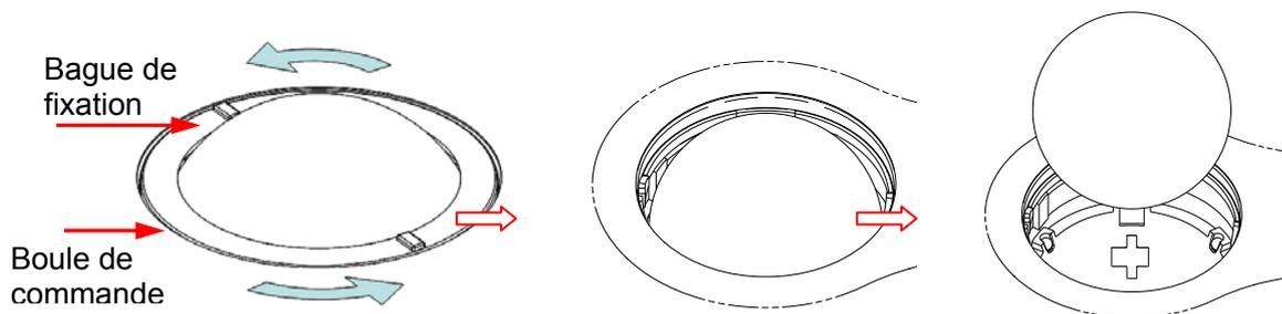
Tournez la bague de fixation de 35 degrés dans le sens inverse des aiguilles d'une montre
