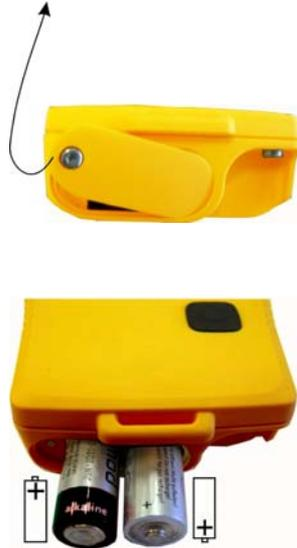
L'appareil utilise deux piles CEI LR6 de taille AA. L'utilisation de piles alcalines est recommandée. La polarité des piles peut être vue sur la photo de droite. Introduire les piles et verrouiller le couvercle piles. L'instrument est alors prêt à fonctionner. Appuyer un court instant sur le bouton-poussoir pour mettre l'appareil en marche.
